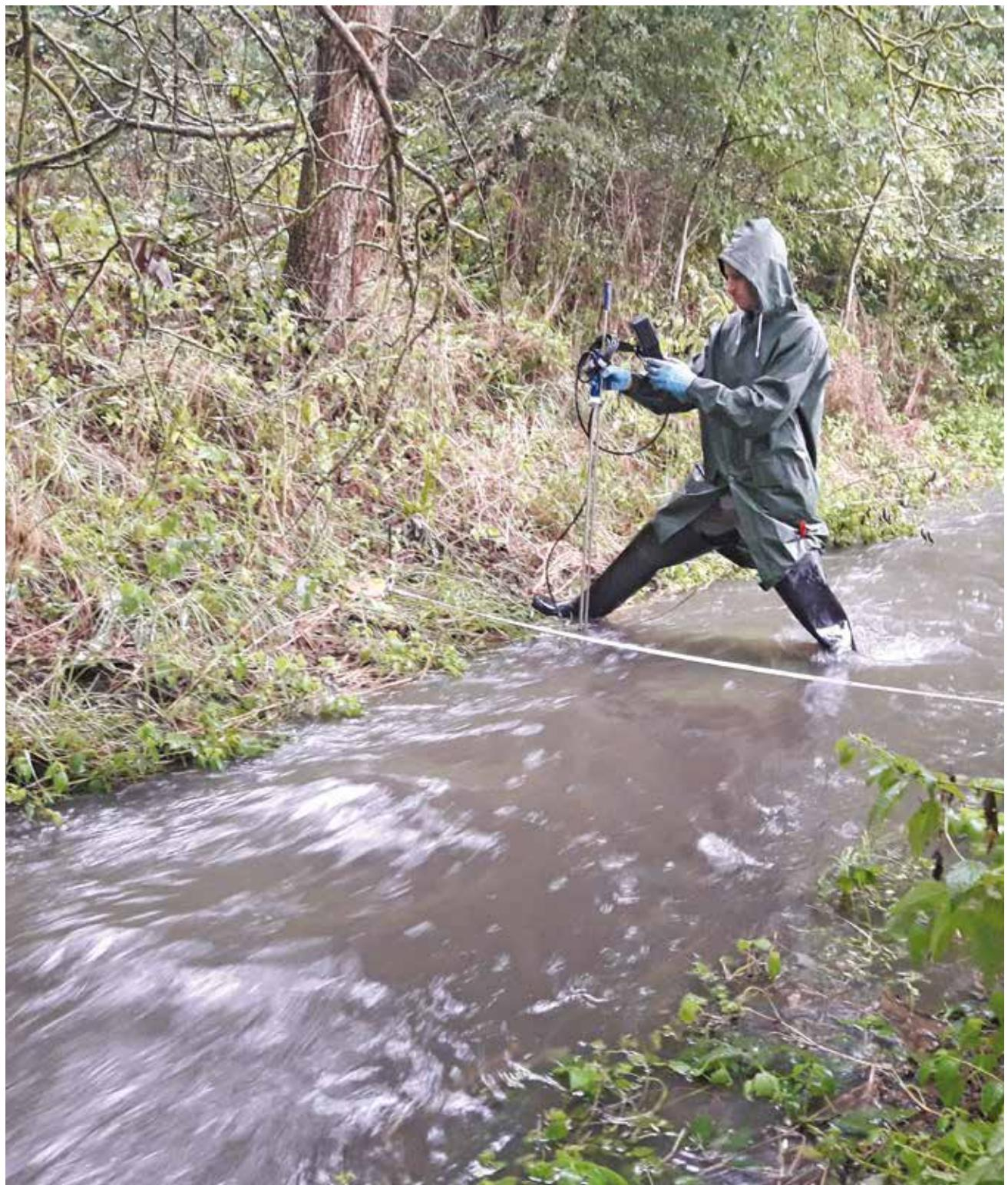
Měření průtoku odlehčované odpadní vody je pro silné povahy. Planá u Mariánských Lázní.
